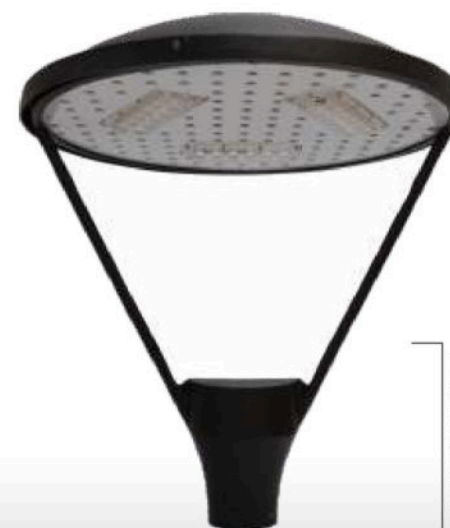
LUMINÁRIA P/ POSTE RAVENNA LP 25 Alt. Total: 18 cm Larg.: 58 cm Quant. Módulos Led: 5 Potência 250 W
